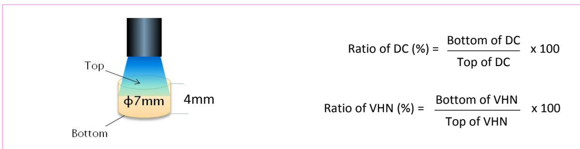
Figura 9 Metodo di polimerizzazione, calcolo
